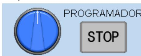
En caso de que no haya ningún programa de riego activado, el programador de riego se desactivará automáticamente.
