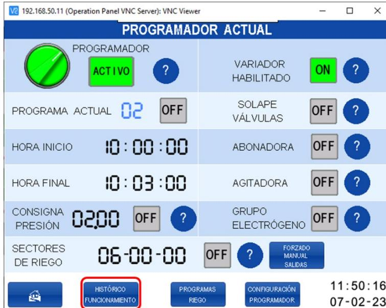
En esta pantalla se muestra el histórico de funcionamiento del programador, cuando se ha activado/desactivado una válvula, el variador, abonadora, etc.
