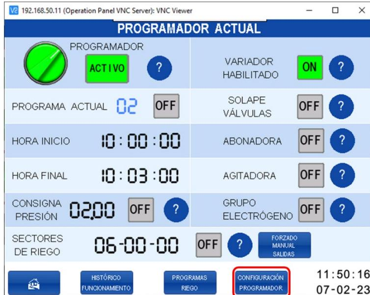
Desde esta pantalla, se puede ajustar la configuración básica del programador de riego. Esta configuración es válida para todos los programas de riego e independiente del tipo de programador usado.
