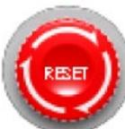
Botón de "reset": Si el variador está en estado de alarma (lámpara parpadeando), es posible hacer un reset del variador.
