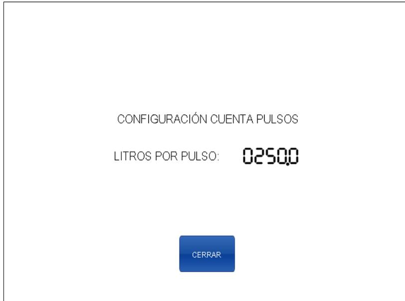
El contador de litros/pulsos, se debe conectar a la entrada digital X1 del PLC.
