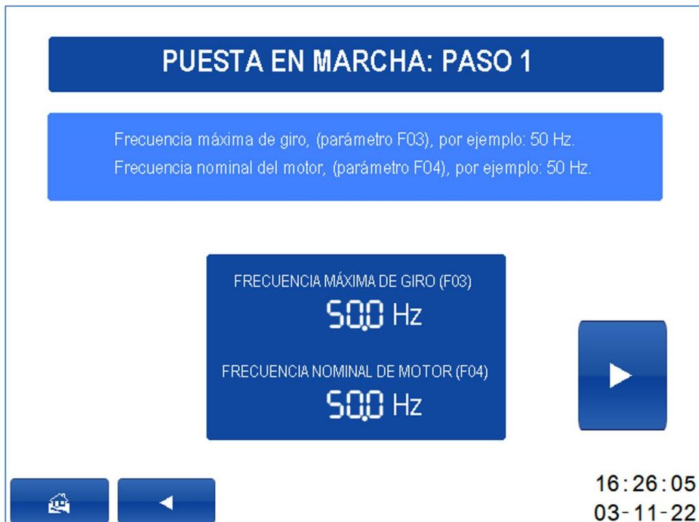
Para cambiar el valor, hay que hacer clic encima del parámetro que se desea cambiar e introducir, mediante el teclado que aparece, el valor deseado (eso sirve para todas las pantallas de puesta en marcha).
