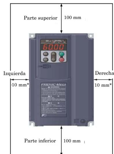
\* Para variadores con un potencia de 1.5 kW o inferior o 30kW y superior, mantenga una distancia de 50 mm a la derecha e izquierda, 100 mm al frente.
